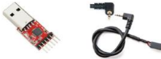
Рис. 4. USB-TTL CP2102 и Mini jack 2.5 mm
