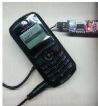
Рис. 5. Подключенный к компьютеру Motorola C118 в режиме Layer 1
